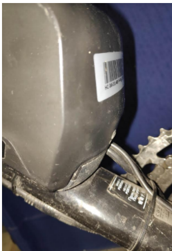
Batterie bien enclenchée
