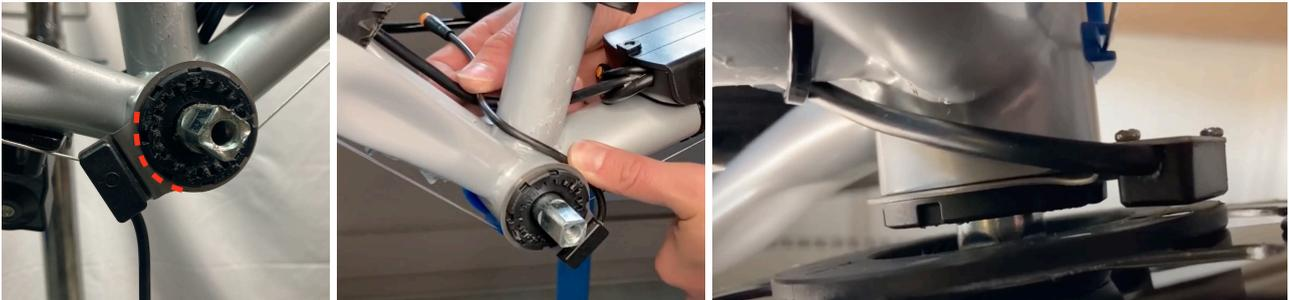
13. Remonter la cuvette de gauche et la manivelle de gauche
