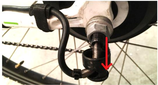
Sortie du câble moteur et encoche vers le sol
