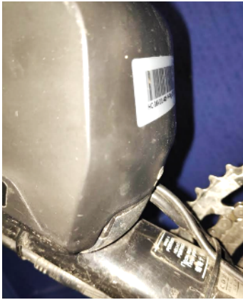
Batterie bien enclenchée
