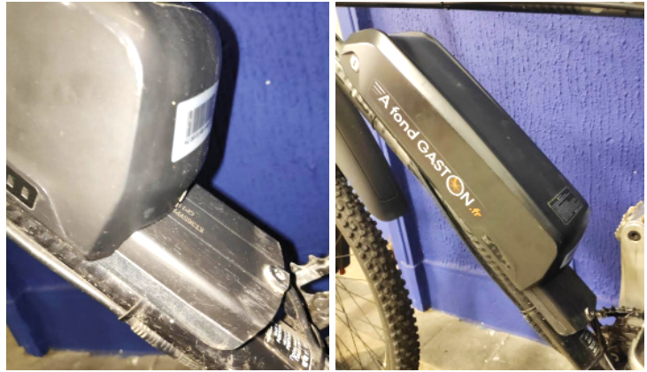
Batterie mal enclenchée
