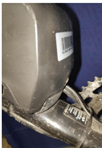
Batterie bien enclenchée
