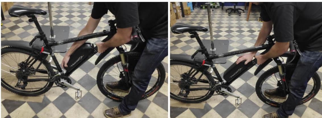
La batterie est bien enclenchée sur le support lorsque celle-ci est alignée avec la partie inférieure du support.
